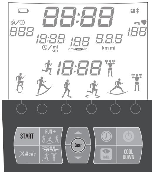
Verwenden Sie den Zero Runner Tastenblock, um Ihre Workouts zu programmieren bevor Sie beginnen, um während des Laufens Einstellungen zu ändern oder um gecoachte Workouts mit RUN+, X-Mode und CROSS CiRCUIT zu programmieren.
