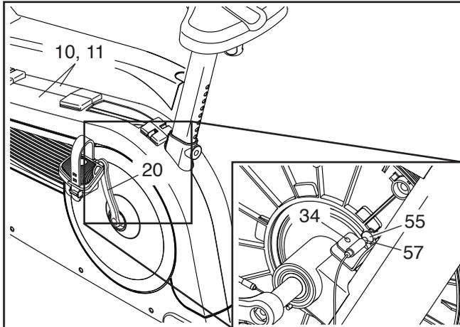
**Vea el dibujo diagrama de abajo a la izquierda.** Tire con cuidado de los toques de los Protectores (10, 11) para separarlos y localice el Interruptor de Lengüeta (57). Gire el Brazo Izquierdo de la Manivela (20) hasta que un Imán (55) quede alineado con el Interruptor de Lengüeta. Luego, afloje levemente el Tornillo M4 x 18mm (34), deslice el Interruptor de Lengüeta levemente hacia el Imán o en dirección opuesta a este y, luego, reapriete el Tornillo.
