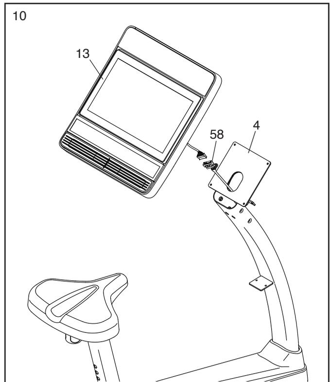
11. **Clave: Evite pellizcar los cables.** Conecte la Consola (13) al Montante Vertical (4) con cuatro Tornillos M4 x 18mm (34); **apriete parcialmente todos los Tornillos y, luego, apriételos completamente.**
