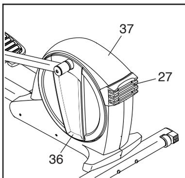
Supérieur (37), puis utilisez un tournevis à tête plate pour faire levier et retirer le Capot Supérieur du vélo elliptique vers le haut. Ensuite, soulevez le Disque de la Pédale (36) gauche et retirez-le du vélo elliptique.
