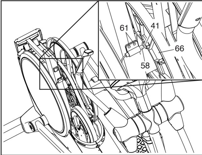
Branchez le bloc d'alimentation, placez l'interrupteur sur la position Reset (réinitialisation), et faites tourner la Poulie (66) pendant quelques instants. Répétez ces étapes jusqu'à ce que la console affiche des données exactes.
