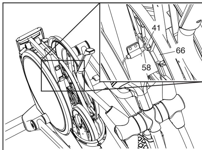
Ensuite, desserrez légèrement les deux Vis M4 x 16mm (61) indiquées. Glissez le Capteur Magnétique (58) légèrement plus près ou plus loin de l'Aimant (41). Puis, resserrez les Vis.
