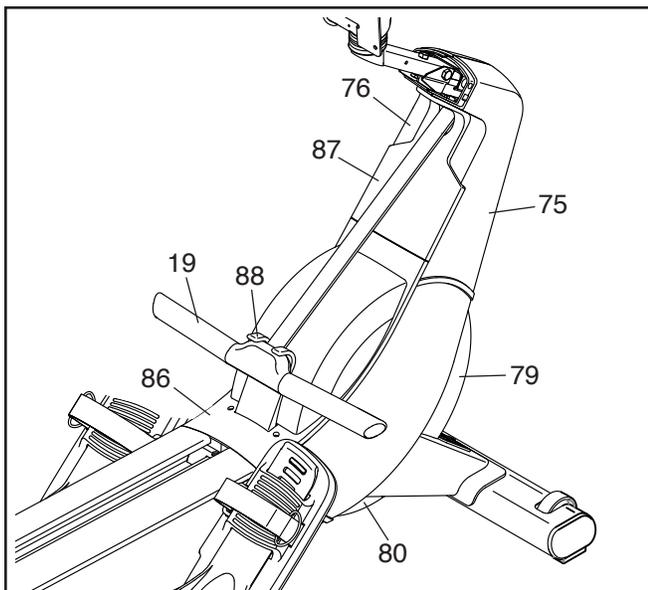
Dann nehmen Sie die Schwungradabdeckung (86), die Riemenabdeckung (87), die vordere Abdeckung (79), die untere Abdeckung (80) und den rechten und linken Schutz (75, 76) vom Rudergerät ab. **Um die Schrauben zu finden, mit welchen die einzelnen Teile befestigt sind, siehe EXPLOSIONSZEICHNUNG A auf Seite 30.**
