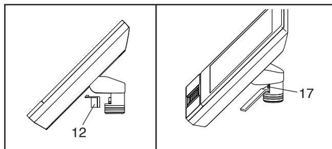
**Falls der Trainingscomputer zu locker zu sitzen scheint oder nicht an der Stelle bleibt, wenn man ihn nach oben oder nach unten neigt, verwenden Sie zunächst einen Flachschlitz-Schraubendreher, um die obere und untere Computerabdeckung (22, 23) abzuhebeln.**
