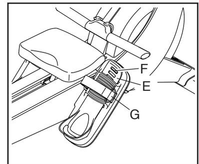
Stellen Sie die andere Fußstütze auf dieselbe Weise ein. Stellen Sie sicher, dass sich beide Fersenhalterungen (E) in der gleichen Position befinden.
