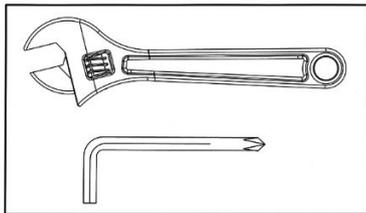
Ziehen Sie alle Schrauben und Muttern fest, nachdem alle Bestandteile in den aktuellen und vorherigen Stufen zusammengebaut worden sind. **ACHTUNG**: Bestandteile mit Drehfunktionen nicht zu fest anziehen.
