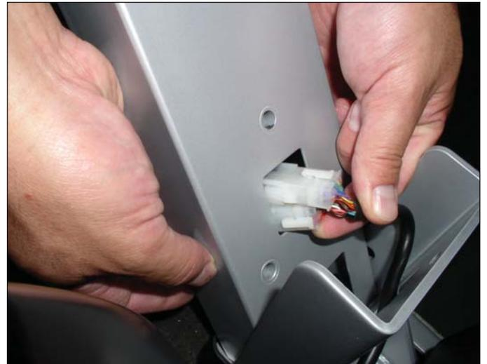
Busque la COLUMNA DERECHA (4). La columna está marcada con una "R". Ubique la COLUMNA DERECHA cerca de la parte interior del soporte derecho. Instale toda la tornillería y ajuste con las manos en este momento. Asegure la COLUMNA DERECHA en el soporte derecho usando tres PERNOS PLATEADOS de M8 X 60 MM (2) y tres ARANDELAS DE ESTRELLA (3). Asegure la parte delantera de la columna instalando un PERNO PLATEADO de M8 X 15 MM (9) y una ARANDELA DE ESTRELLA (3).
