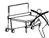
Ne pas prendre appui sur la traverse ou sur les pieds pour tirer la poignée rouge de déverrouillage, risque de basculement.
