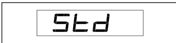
**Test display:** questa opzione serve ai tecnici della manutenzione per capire se il display funziona correttamente.
